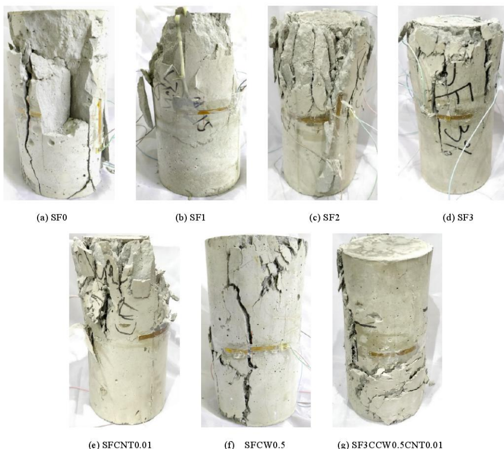
图 6 UHPC 抗压破坏形态
